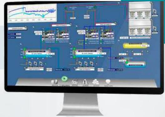
Los paneles de control permiten adicionar al sistema de combustión todo tipo de componentes industriales capaces de realizar tareas de monitoreo y control a distancia ya sea en computadoras o otras pantallas HMI a través de sistemas SCADA o por medio de servidores en la WEB; con los cuales se pueden generar reportes de funcionamiento, reportes de fallos, tendencias de operación, cambio de variables, programación de rutinas, graficación de variables, análisis de datos y prevención de daños.
